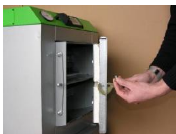
Fot.5. Wyjąć podzespoły mocowania uchwytu.
