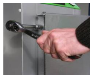
Fot.8. Przykręcić śruby montażowe zawiasów
