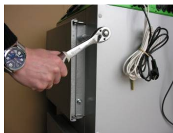
Fot.6. Zdemontować drzwiczki z włazu.
